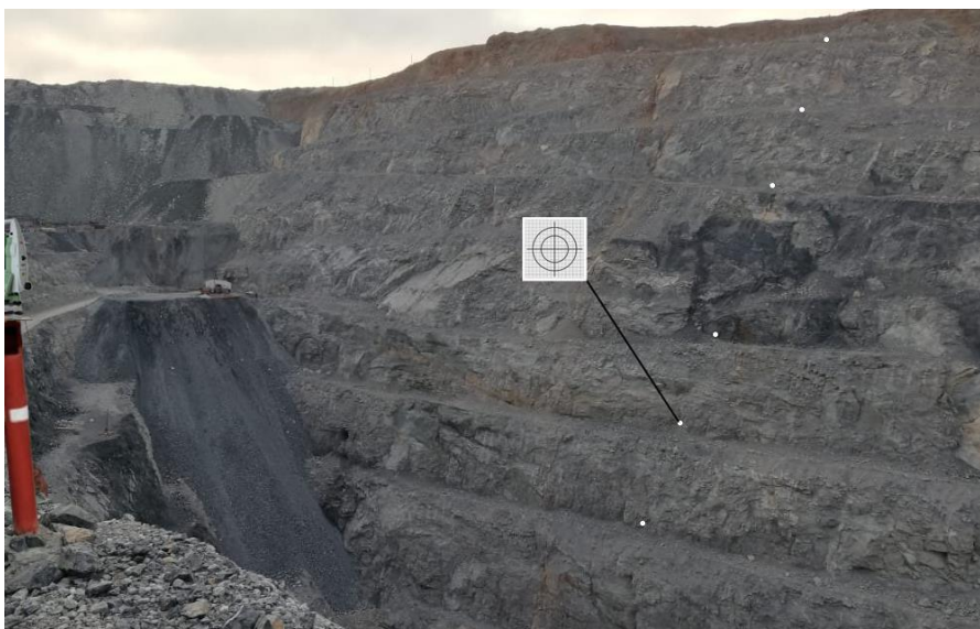
Сурет 3.12 - Жарқырағыш маркалардың көмегімен карьер беткейлерін мониторингтеу [31]
