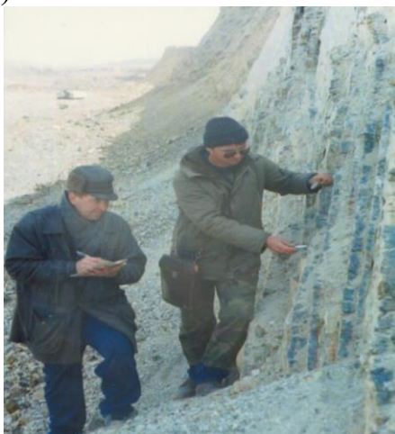
Сурет 2.8 - Таужыныстарының жарықшақтарын түсіру: а – тау-кен компасымен; ә- тұрақты пунктке орнатылған лазерлік сканермен түсіру
