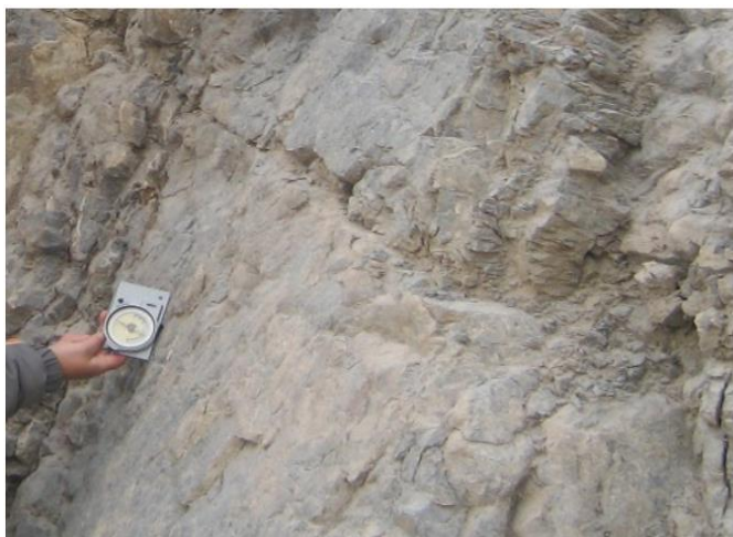
Сурет 2.7 – Таужыныстар массивінің жарықшақтылығын тау компасымен өлшеу
